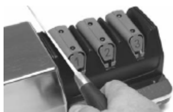
Zdj.5 Stopień 1-umieszczenie ostrza w gnieździe pomiędzy prowadnicą a sprężyną, pamiętaj aby powtórzyć procedurę w prawym i lewym gnieździe.
