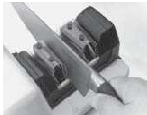
Rysunek 3: Nóż jest wkładany pomiędzy prowadnicą Ostrza oraz plastikową sprężyną dopóki krawędź nie osiadzie na Płytkę Podtrzymującej Ostrze.
